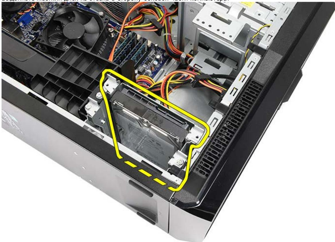
6. Выверните два винта, которыми жесткий диск крепится к корзине для дисков.
