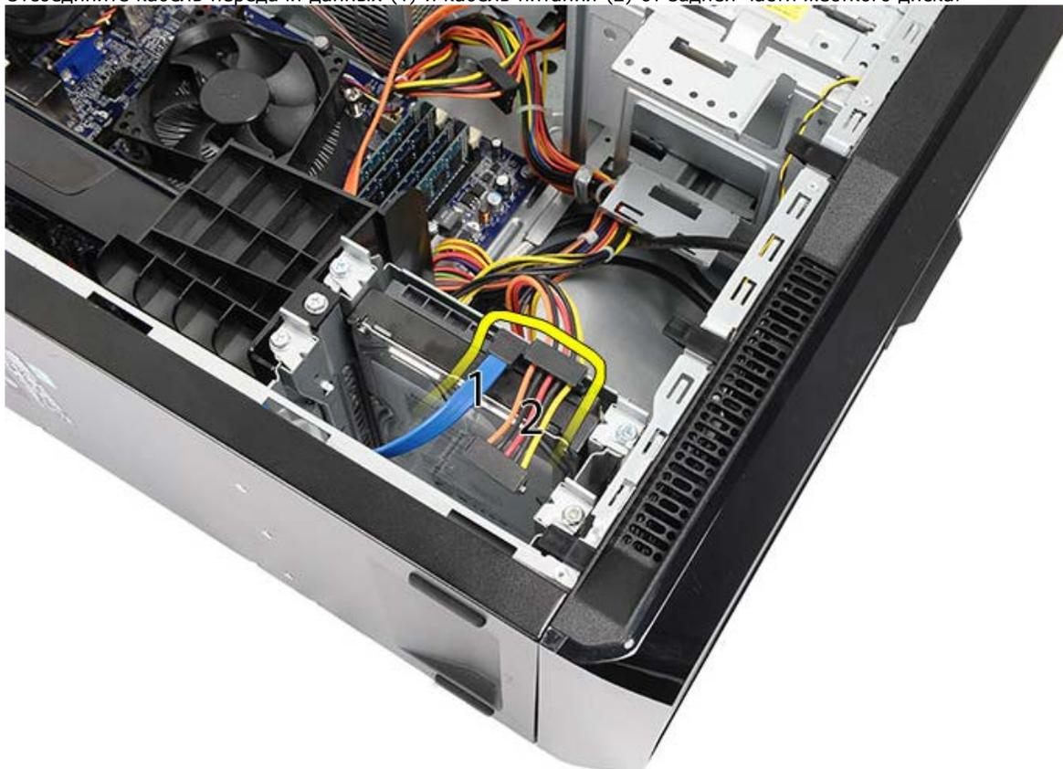
4. Выверните два винта, которыми корзина для жестких дисков крепится к корпусу компьютера.
