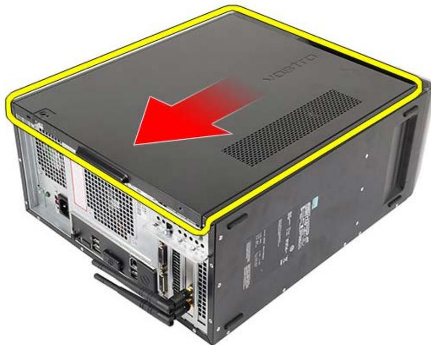
4. Приподнимите крышку корпуса компьютера и снимите ее с компьютера.
