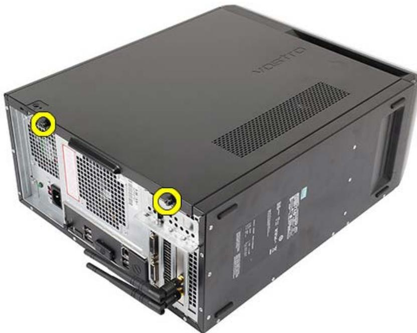
3. Сдвиньте крышку корпуса компьютера в сторону задней части компьютера и снимите ее с компьютера.
