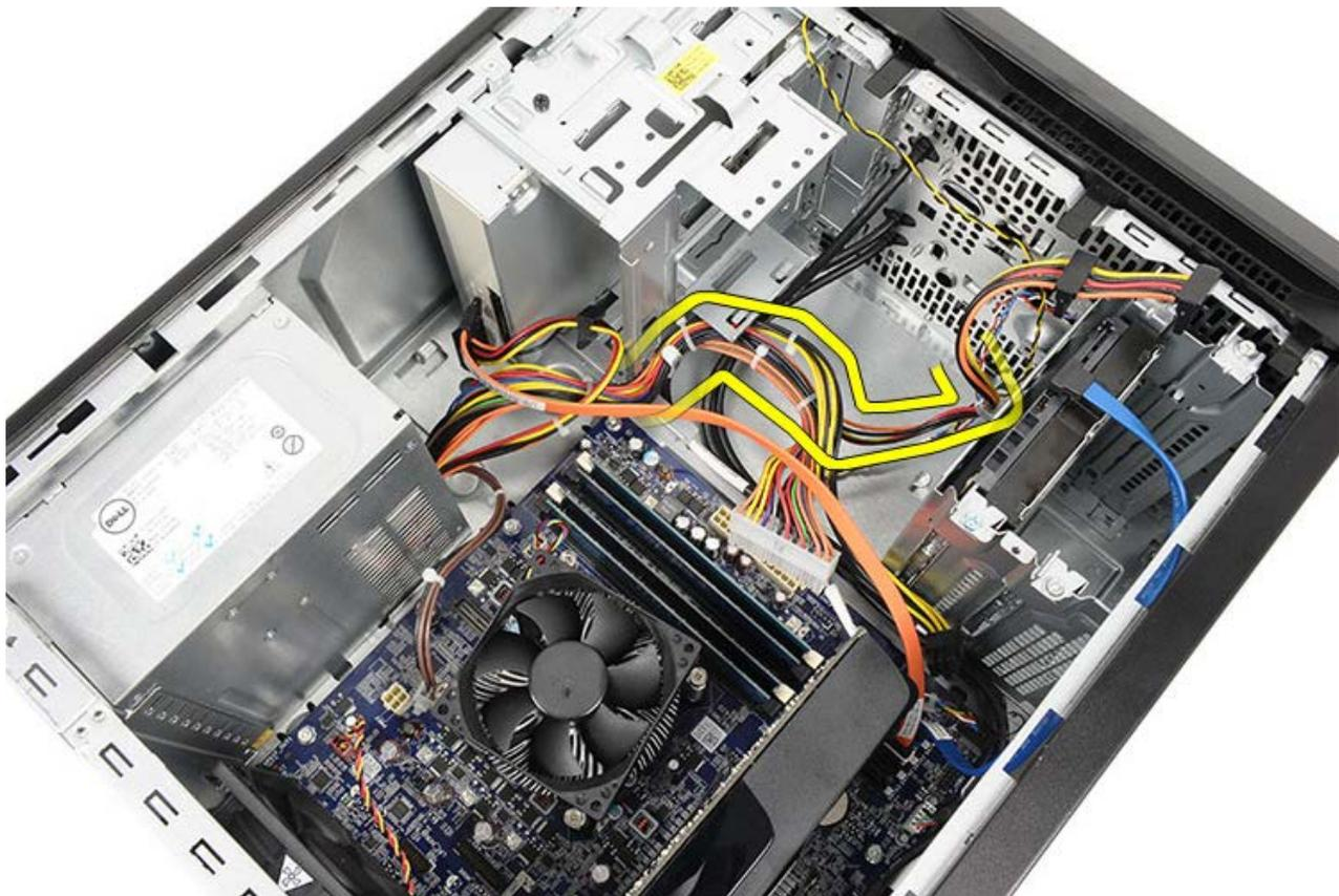
6. Выверните винты, которыми блок питания крепится к корпусу компьютера.
