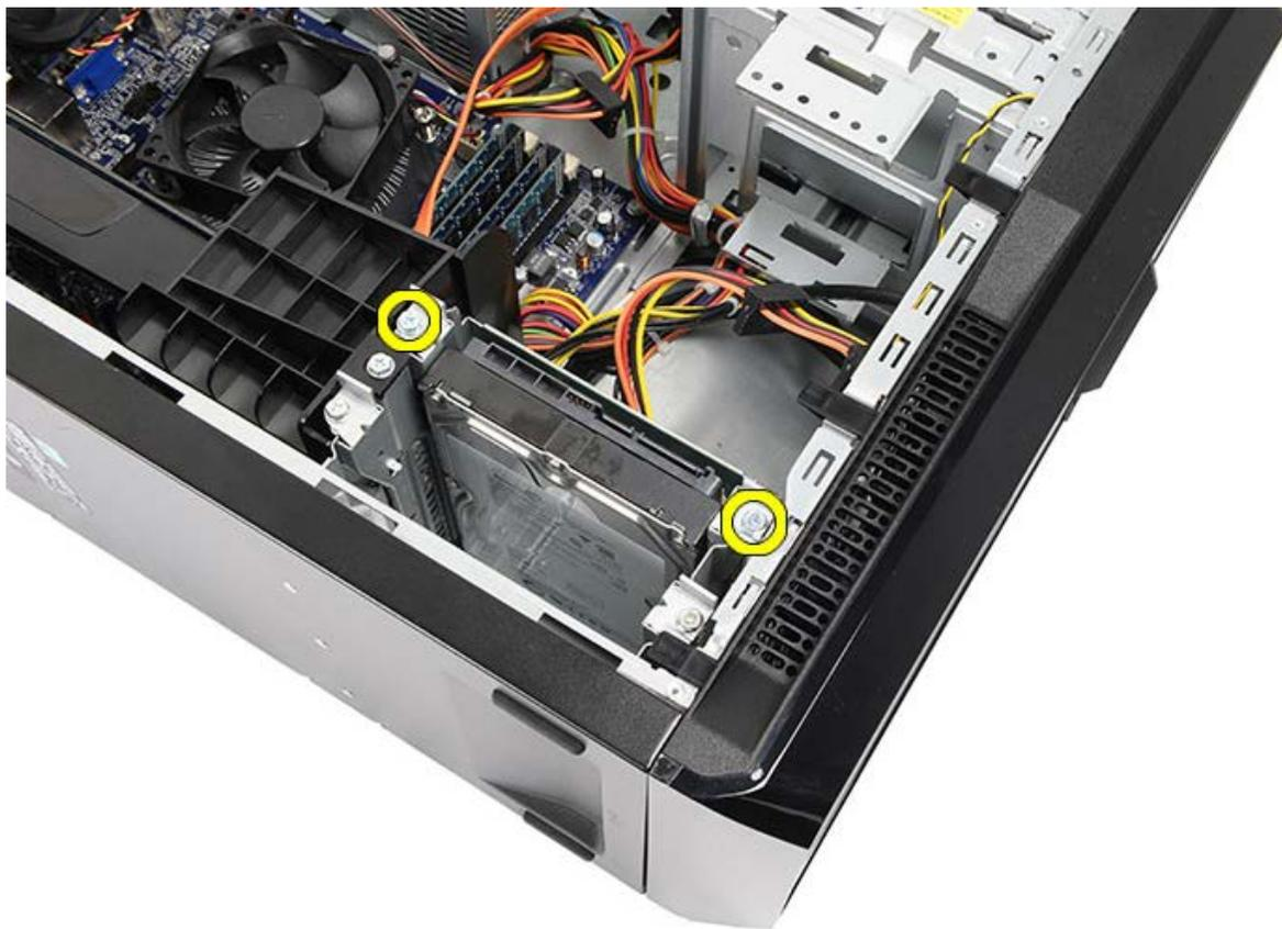
5. Выдвиньте жесткий диск из отсека в сторону боковой части компьютера.
