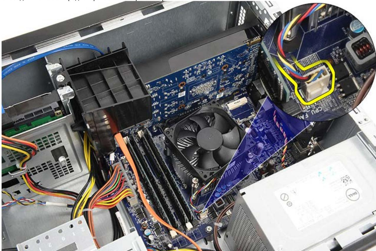
4. Ослабьте четыре невыпадающих винта, которыми радиатор/вентилятор в сборе крепятся к системной плате.
