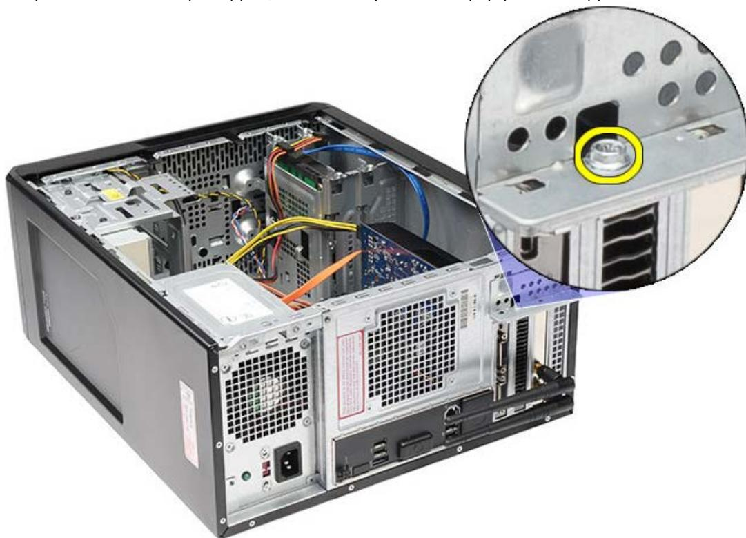
5. Снимите металлическую фиксирующую пластину с корпуса компьютера.
